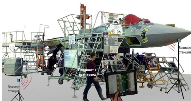
Рисунок – 3 Схема позиционирования модели в цехе
