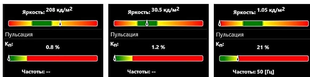
Рисунок 1 – Результаты измерений IPS матрицы
