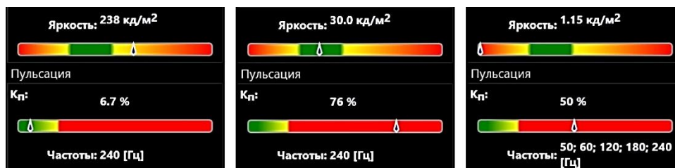
Рисунок 2 – Результаты измерений OLED матрицы с повышенной пульсацией
