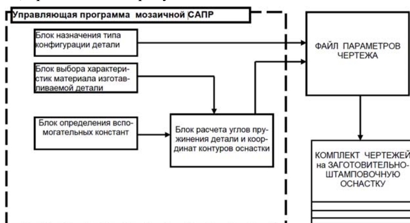
Рисунок 3 – Обобщенная схема функционирования прикладной САПР изготовления нервюр самолета
