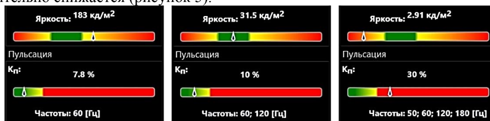
Рисунок 5 – Результаты измерений AMOLED матрицы с пониженной пульсацией
