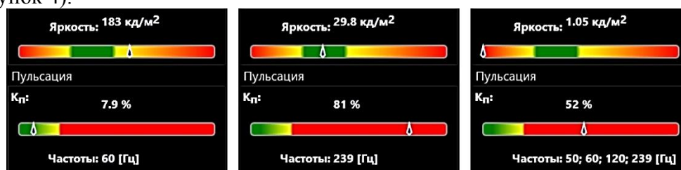
Рисунок 4 – Результаты измерений AMOLED матрицы с повышенной пульсацией
