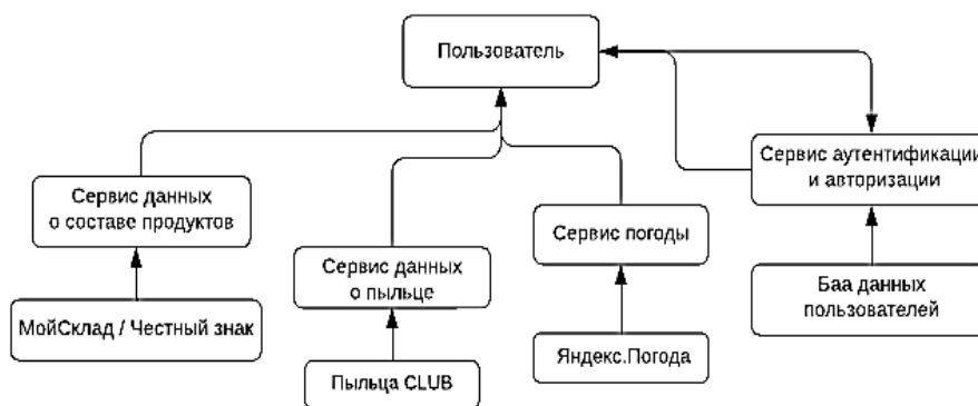
Рисунок 7 – Микросервисная архитектура приложения
