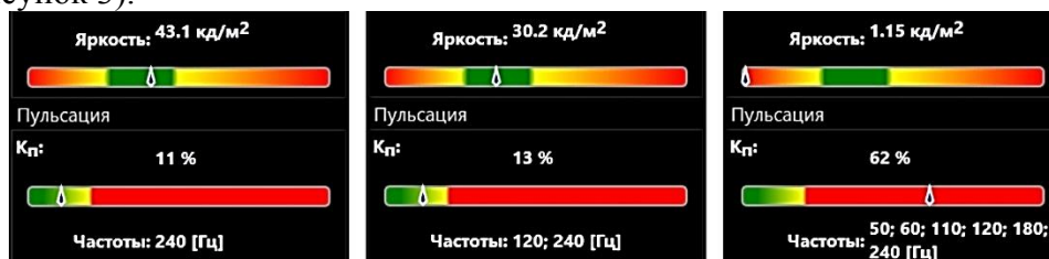
Рисунок 3 – Результаты измерений OLED матрицы с пониженной пульсацией
